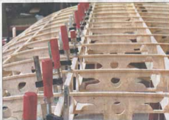
Akribisch genau sind beim „Autoplan“-Nachbau die Klebestellen ausgeführt.
