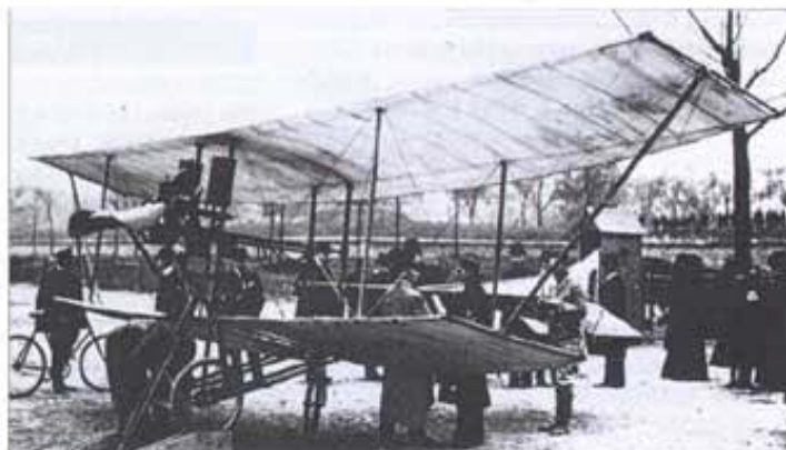
Pischofs Erstling, 1907: mit 25-PS-Anzani und Propeller von Chauvière, dem ersten konsequent entwickelten Prop in Europa
