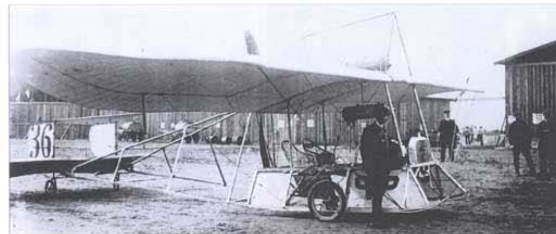
Autoplan: Handkurbel zum Starten des Motors, Zahnräder, Kette und Fernwelle für die Kraftübertragung
